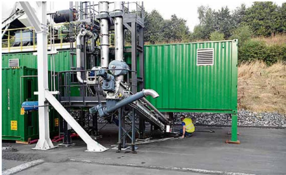
La machine de la société ETIA - dont un modèle sera installé à Gland - qui permet de chauffer à 850°C, en l'absence d'oxygène, des déchets plastiques et de dégager ainsi un mélange de gaz qui peut faire tourner une génératrice à combustion. (LDD)
